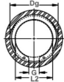
直径间隙&安装在沟槽中间隙的直径
